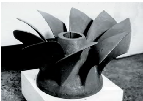
Рабочее колесо первой отечественной гидротурбины, выпущенной в 1926 г. на Металлическом заводе.
